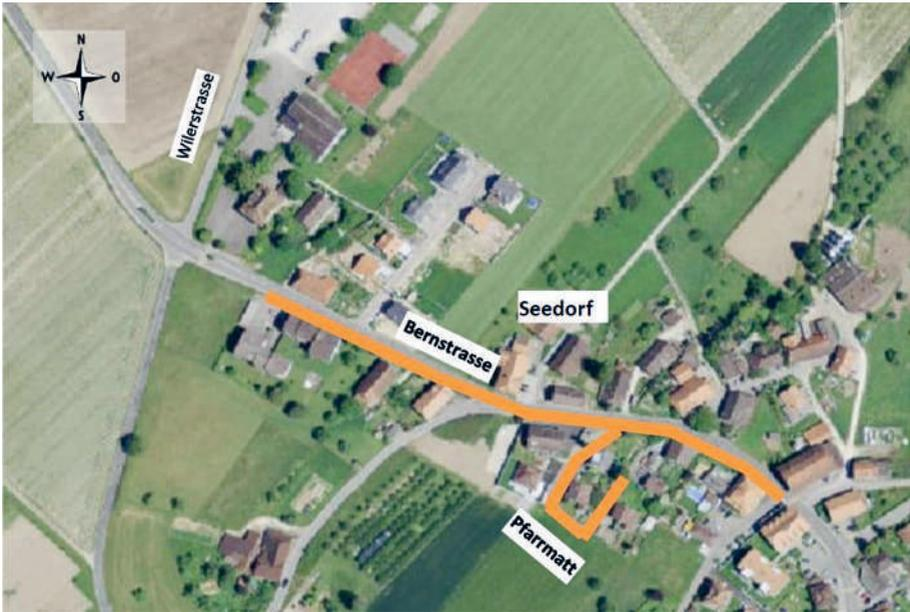
Abb. 3: Neubau Fernwärme-Hauptleitungen
