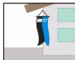
Heraldische Fahnen ausserhalb des Freihalte- und Lichtraumprofils von Geh-, Radweg und Strasse
