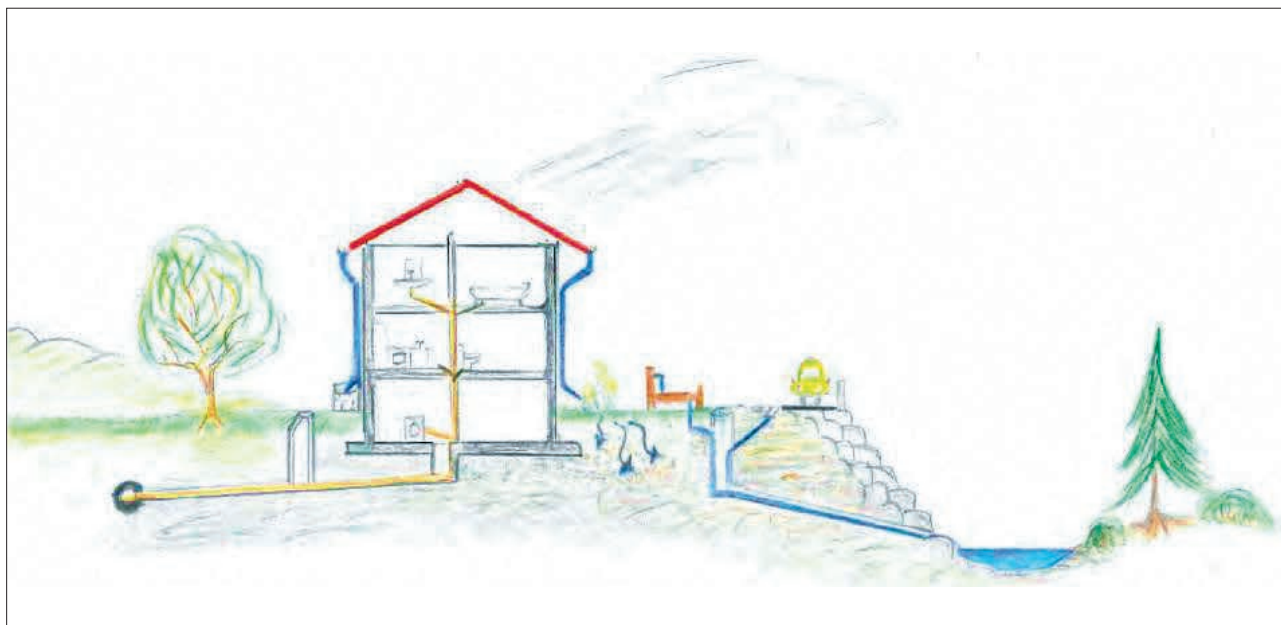
Trennsystem: getrennte Schmutz (ARA)-Leitung und Regenwasserleitung (Bach)
